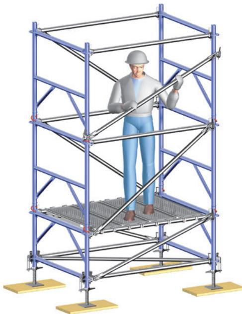
► **Acceso integrado.** Las plataformas de montaje se van trasladando de metro en metro en altura, y se utilizan los travesaños de los marcos TG60 como peldaños de escalera interior, así el nivel superior dispone en todo momento de una superficie segura y ergonómica para continuar con el montaje.
